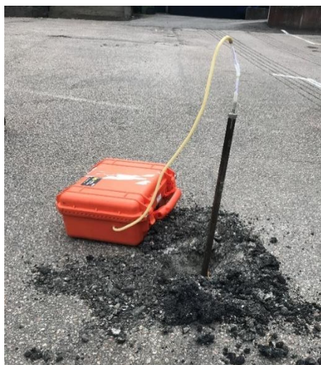
Figur 2. Provtagning av porluft i provpunkt 2004, på fastigheten Rödjan 8, Trollhättan.
