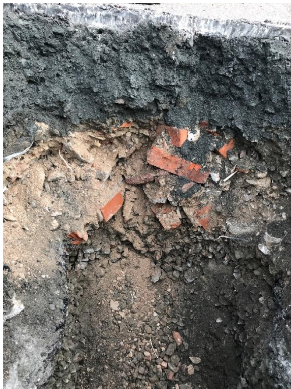
Figur 5. Jordprovtagning i provpunkt 2003. Dubbla lager asfalt där det undre lagret ses på ca 0,6 m djup.
