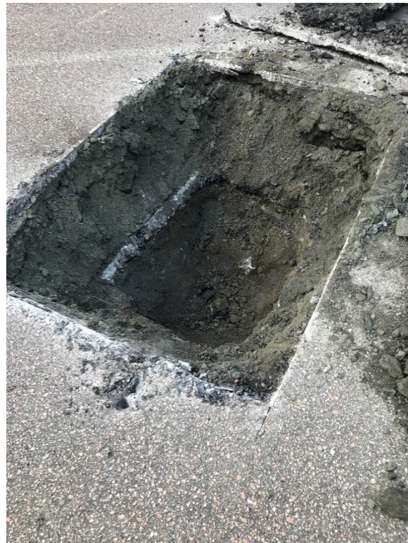
Figur 4. Jordprovtagning i provpunkt 2002. Det undre lagret av asfalt ses på ca 0,5 m djup.
